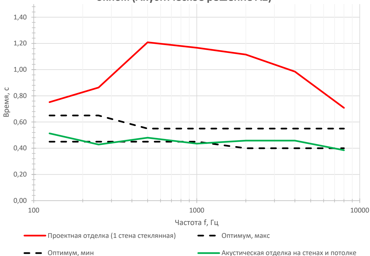
Рис.4.2.2. Время реверберации T30 в октавных полосах частот. Расчетные значения без акустической отделки и с акустической отделкой (Вар.А2) в сравнении с коридором оптимумов.
